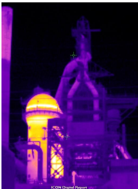
Imagens de um alto-forno realizadas em Onda Longa (7,5 a 14 micrometros).
