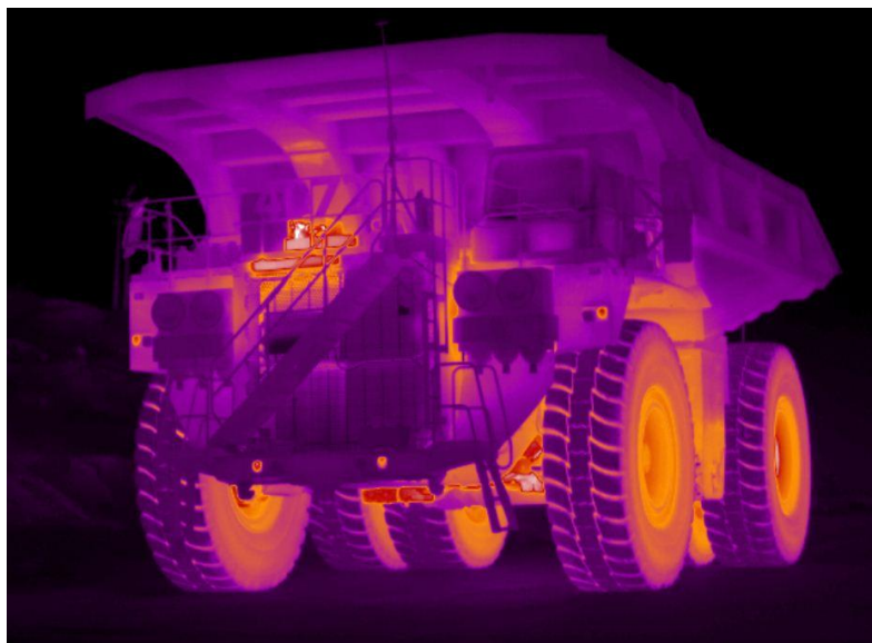
Imagem infravermelha de um caminhão fora de estrada (OHT) utilizado no transporte de minério de ferro (mina de Carajás – Pará -Brasil).
