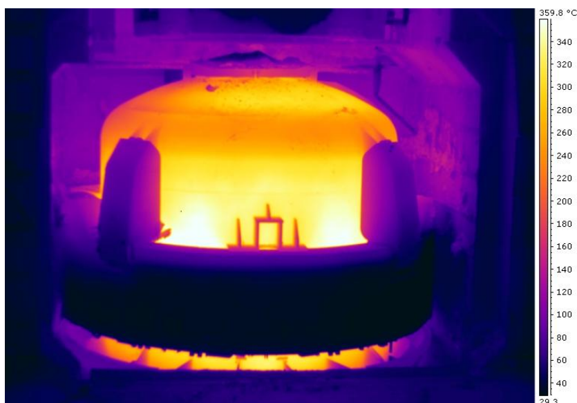
Imagem do fundo de um conversor LD, realizada em Onda Longa (7,5 a 14 micrometros).
