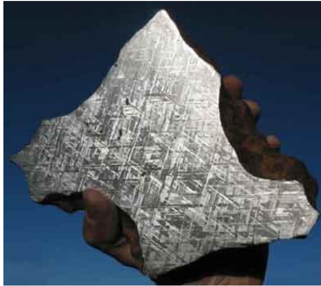
Meteorito de hierro y níquel mostrando una estructura cristalina denominada Widmanstätten.
