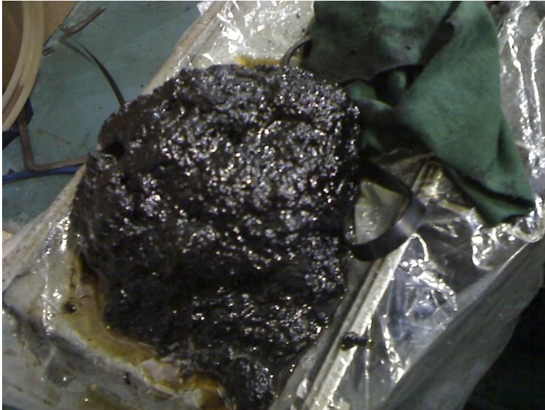
Fig. 3 se observa el sedimento que salio del aceite, al no estar el sistema de enfriamiento bien, el aceite calienta y empieza a sedimentar impurezas
