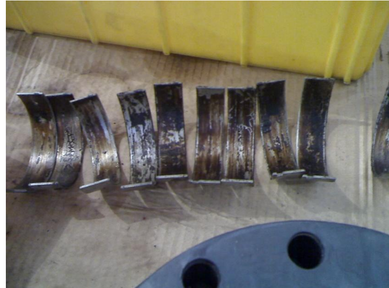
Fig. 4 tener aceite operando con elevada temperatura cambia su viscosidad por lo que no es posible la lubricación correcta y genera daño en el cigüeñal, los casquillos están completamente dañados
