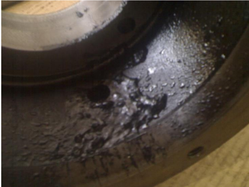
Fig. 5 segmento donde esta instalado el sello mecánico y agujero de lubricación de rodamientos, el sedimento en casos anteriores llego a taparlo provocando daño irreversible en cigüeñal.
