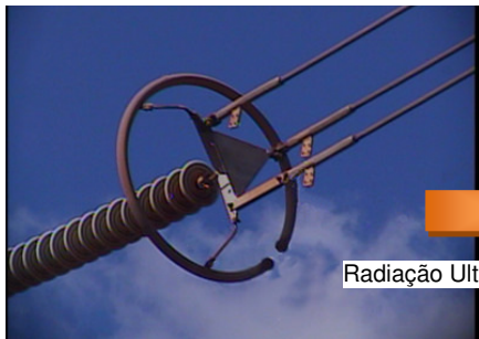
FIGURA 6 – Combinação da imagem visível e da radiação UV pela Detecção de Corona por UV.
