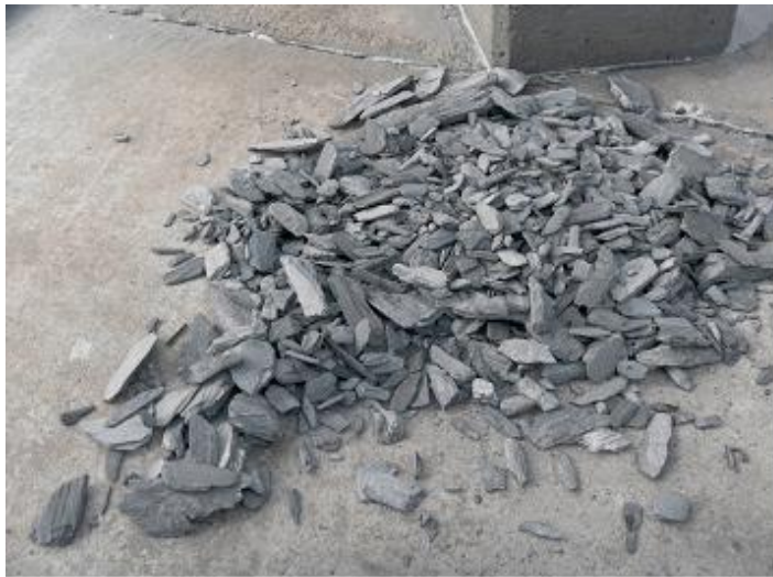
Restos de material desprendidos del interior de la cañería.
