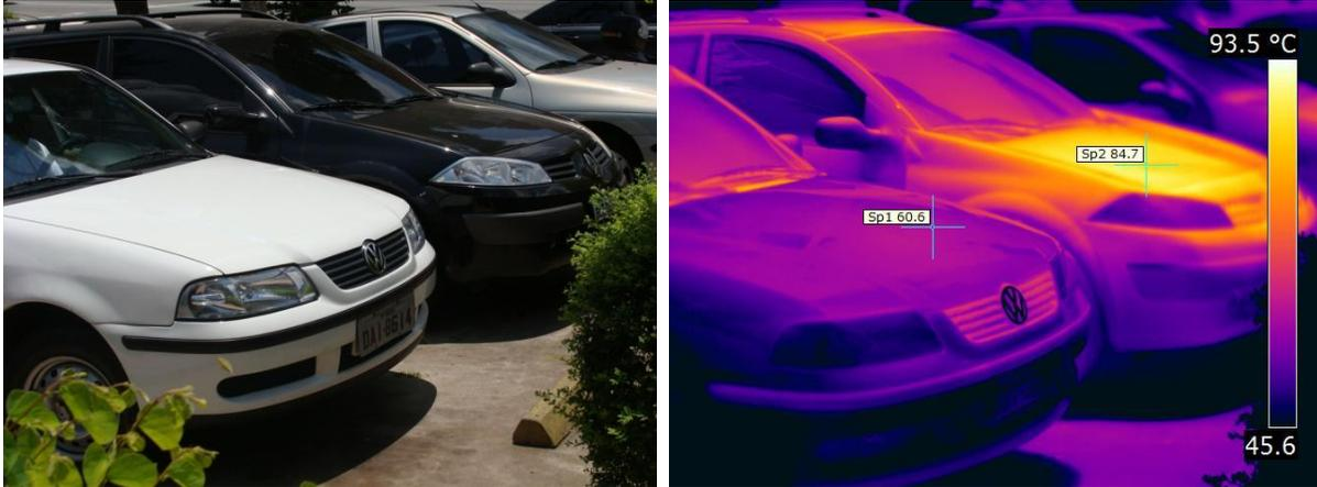
Diferencia de temperaturas en automóviles con pinturas blanca y negra, bajo carga solar.
