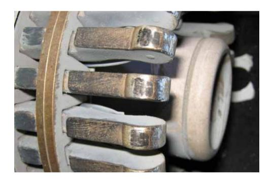
O aumento da resistência de contato é devido principalmente a impregnação dos resíduos da decomposição do gás SF6 nos contatos do disjuntor.
