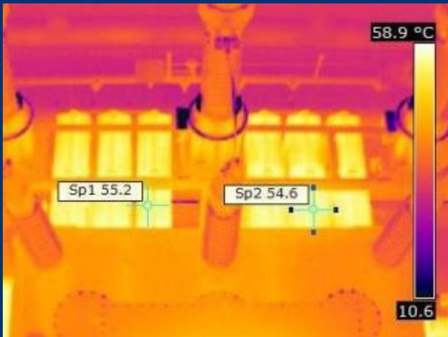
Visto desde arriba. Delta T de 0.6 ° C Superior en los enfriadores del lado derecho.
