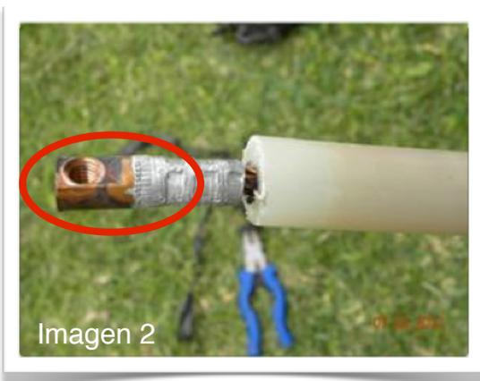
Se puede observar la construcción de estas botas (imagen 1), en el círculo se marca el punto de conexión, lugar donde la espiga (imagen 2) tiene su punto de fijación mecánico.
