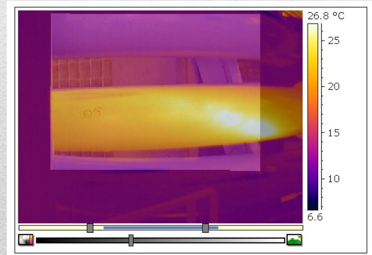
Verificando que es constante la trayectoria que sigue el grano se localizaron los puntos de mayor temperatura y se verifico el espesor en esa sección dando diferencias con los espesores tomados en los puntos donde se realiza la medición periódica.
