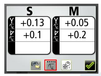
O segundo passo é o de minimizar os efeitos da vibração. O Fixturlaser NXA Pro possui dois programas de forma padrão para minimizar as variações causadas por vibração no local de trabalho: Tempo de Amostragem (utilizado para a medição) e Filtro Ajustável (usado durante o ajuste).
