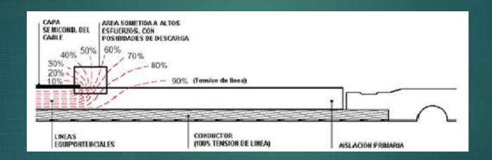
Como se observa en la figura, con el tubo de control de campo instalado, las líneas equipotenciales son dispersadas, distribuyendo el campo eléctrico y reduciendo los esfuerzos a niveles que no dañen la aislación. Esto consigue por medio de un tubo termocontraible de propiedades resistivas y capacitivas especiales.
