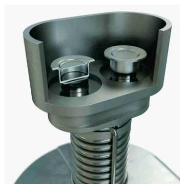
Figura 3 – Detalhe de um forno metálico de um DSC, com detalhe da amostra à esquerda. [4]
