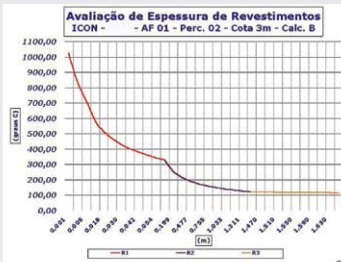
Imagem 08: Avaliação de espessura de revestimentos em equipamentos
